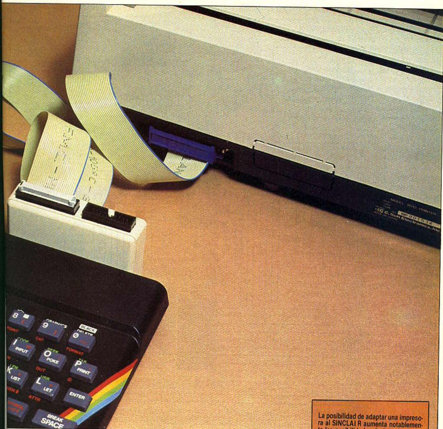
La posibilidad de adaptar una impresora al SINCLAIR aumenta notablemente las posibilidades de este. Mediante el montaje que presentamos, se puede adaptar fácilmente la impresora al Spectrum.
